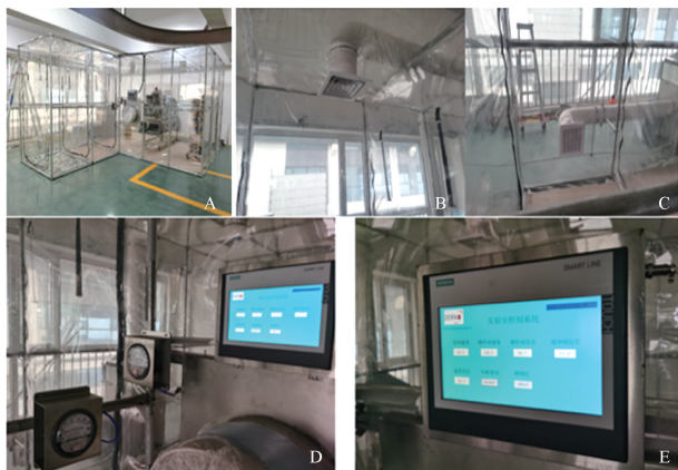
注:A.膜结构实验装置的整体外观;B.送风口; C.排风口;D.压差表;E.控制系统。
